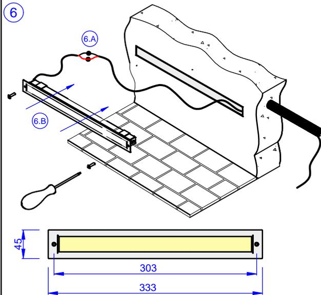
6.A. VERBINDEN SIE DIE LEUCHE MIT DEM DRAHT. DIE VERBINDUNG MUSS IP66 SEIN.
