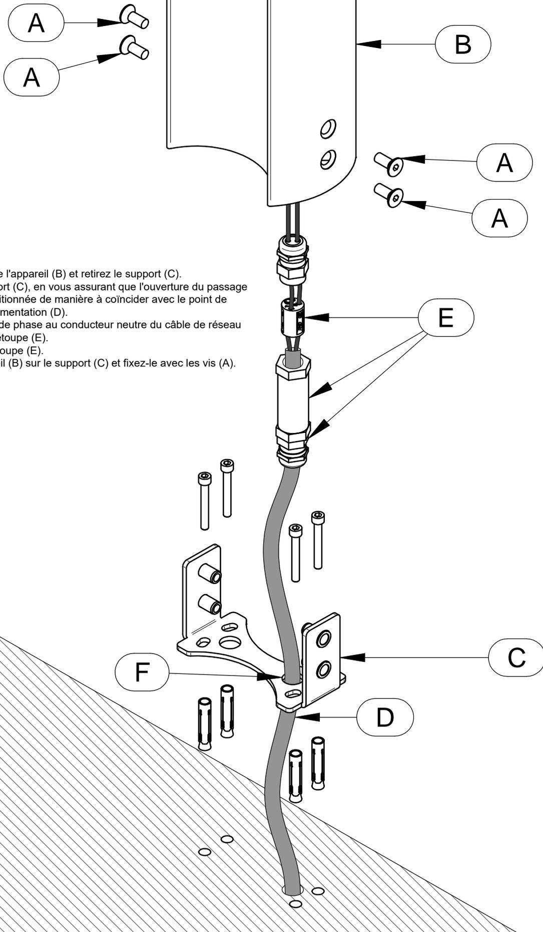
Retirez les vis (A) de l'appareil (B) et retirez le support (C).
