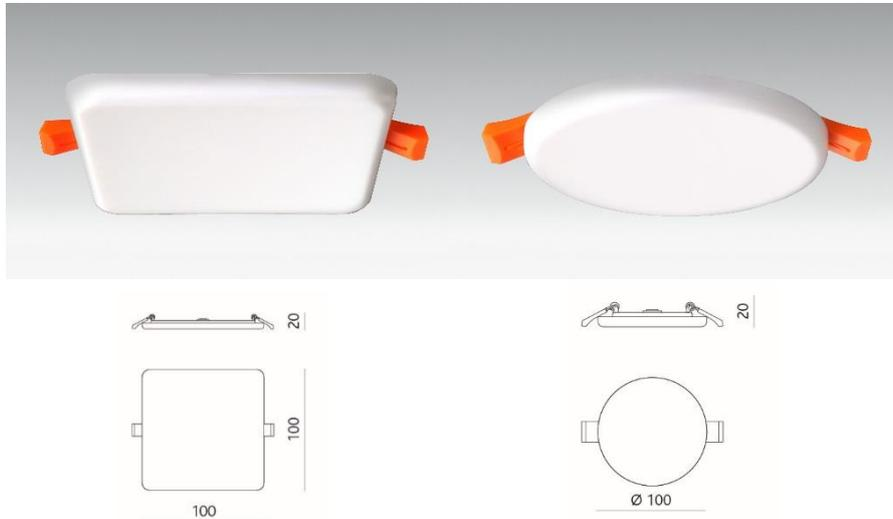
Aluminium-Druckguss, Bügelfedern, Diffusor satiniert (homogene Ausleuchtung), inkl. dimmbarem Konverter, Verbindungsstecker zwischen Leuchte und Konverter für vereinfachtes Installieren, Vorderseite weiss, max. Deckenstärke: 1 - 25 mm
