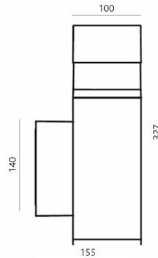
Aluminium-Druckguss, Polyester-Epoxy-Pulverbeschichtung (UV-beständig), Aluraster, Dif-fusor aus klarem Polycarbonat (UV-beständig), Silikondichtung, asymmetrisch nach unten strahlend 270°, Lichtaustrittsrichtung 360°, IK07, Lebensdauer: 50'000 Std. / L70
