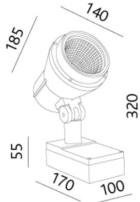
Aluminium-Druckguss, Polyester-Epoxy-Pulverbeschichtung (UV-beständig), Sicherheitsglas, Silikondichtung, IK07, Lebensdauer: 50'000 Std. / L70
