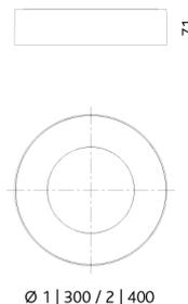
Kunststoffgehäuse, Diffusor aus opalisiertem Polycarbonat, direktstrahlend, Farbtemperatur umschaltbar 3000 K / 4000 K / 5700 K, IK08, Lebensdauer: 50'000 Std. / L70, dimmbar mit Phasenabschnitt-Dimmer.
