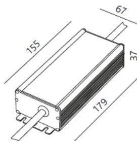
Encapsulé dans un boîtier plastique, précâblé (PRI) 50 cm et (SEC) 50 cm, tension de sortie régulée, coupure en cas de court-circuit avec remise en route automatique, rendement élevé, peu de puissance dissipée, électronique, testé aux normes RoHS et ENEC
