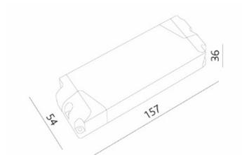
Kunststoffgehäuse, Konstantspannung 24V, Überlastschutz
