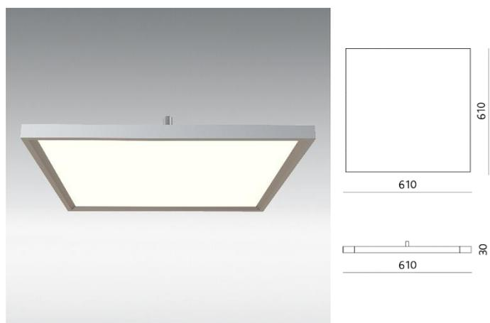
Gehäuse Aluminium, Diffusor aus mikroprismatischem Polycarbonat, DALI dimmbar, Strangpressprofil aus pulverbeschichtetem Aluminium, Lebensdauer: 50'000 Std. / L80
