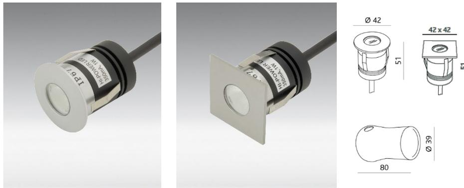
Massivaluminium gedreht, Abdeckung Edelstahl, Glas strukturiert, drei Blattfedern, Silikonichtung, mit 3 m Anschlusskabel, inklusive Einbauhülse (offen) aus Aluminium, IK10, Lebensdauer: 90'000 Std. / L90
