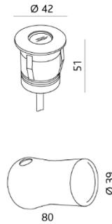
Massivaluminium gedreht, Abdeckung Aluminium eloxiert, Glas strukturiert, drei Blattfedern, Silikondichtung, mit 3 m Anschlusskabel, inklusive Einbauhülse (offen) aus Aluminium, IK10, Lebensdauer: 90'000 Std. / L90
