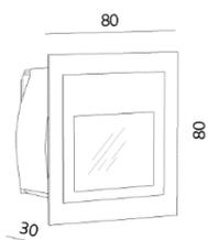
Corps en tôle d'aluminium, ressorts latéraux, couvercle avec verre amovible, source lumineuse décalée vers l'arrière, réflecteur intégré
