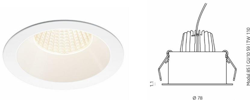
Corps en aluminium tourné dans la masse, ressort à tension, fermeture à système click, source lumineuse décalée de 25 mm vers l'arrière, sans effet éblouissant latéral, sans perte lumineuse, verre de sécurité clair, joint en silicone.
