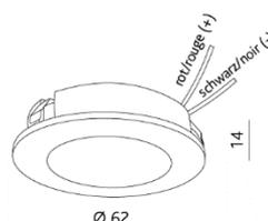
Corps en aluminium tourné dans la masse, verre de sécurité satiné, ressorts latéraux, câbles gainés de silicone, câble d'alimentation / prise AMP exclu, approprié pour le montage en meubles et constructions en bois aux profondeurs d'encastrement réduites (p. ex. placards de cuisine)
