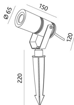
Corps en fonte d'aluminium, finition par poudrage en polyester (résistante aux rayons UV), verre de sécurité transparent/satiné, orientable, pieu, avec 3 m de câble d'alimentation H05RN-F, IK07, durée de vie : 60'000 h / L90
