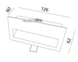
Corps en acier inoxydable, ressorts à tension, boîtier d'encastrement de métal exclu, câbles gainés de silicone
