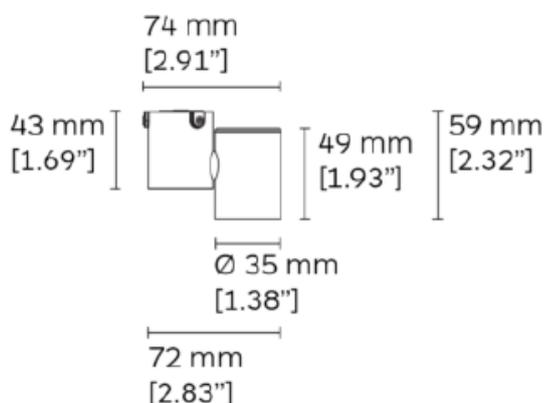
Aluminium moulé sous pression, verre de sécurité, angle de rayonnement 15°, pivotant sur 350°, avec câble d'alimentation 50cm
