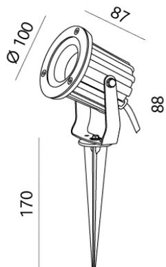
Corps en fonte d'aluminium, anneau en acier inoxydable AISI 316, orientable, verre de sécurité 3 mm, pieu, 3 m de câble d'alimentation H05RN-F avec fiche T12
