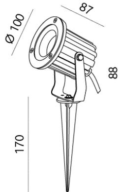
Aluminium-Druckguss, Abdeckung Edelstahl AISI 316, Sicherheitsglas 3 mm, Erdspieß, 3 m Anschlusskabel H05RN-F mit Stecker T12
