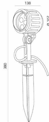
Aluminium-Druckguss, Pulverbeschichtung, Sicherheitsglas klar, mit Erdspiess Kunststoff (PVC), 3 m Anschlusskabel H05RN-F mit Stecker T12, IK07, Lebensdauer: 35'000 Std. / L70
