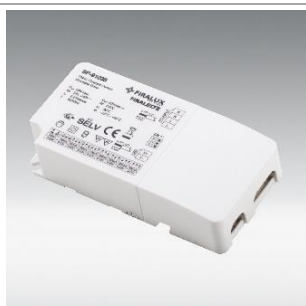
Convertisseur FIRALED® 10W TRIAC SP-91035 Corps en plastique, tension de sortie constante, protection court- circuit et protection de surtension intégrée, testé aux normes TÜV, dimmable phase descendante, courant secondaire sélectionnable au moyen d'un interrupteur à bascule: 190 mA (6 - 40 V) / 260 mA (6 - 40 V) / 300 mA (6 - 33 V) / 350 mA (6 - 28 V)
