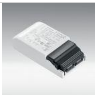
Convertisseur LED DALI FIRALED® SP-92035-A Corps en plastique, tension de sortie constante, protection court- circuit et protection de surtension intégrées, courant secondaire sélectionnable au moyen d'un interrupteur à bascule: 190 mA (6 - 40 V) / 260 mA (6 - 40 V) / 300 mA (6 - 33 V) / 350 mA (6 - 28 V), testé aux normes TÜV, DALI dimmable, adressable, pré-réglage 350 mA, IP20, 3 W – 10 W
