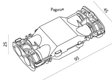
Gehäuse aus Polyamid 66-RV (Nylon), Einsatz mit innovativem Silikon-Gel garantiert eine sichere Abdichtung trotz der temperaturabhängigen Wärmedehnung, einfache Handhabung, Box kann wieder geöffnet werden, durch spezielle Kerben in der Kabelführung werden die Kabel beim Verschliessen der Box gegen Zuglast gesichert, 8/2 Schnapp-Verriegelungen, rostfreie Schrauben zum Verschliessen der Box, Anschlussklemme, Temperaturbeständig -50°C bis + 150°C.
