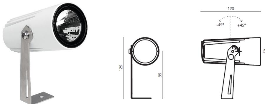
Corps aluminium moulé sous pression, diffuseur verre extra clair, distribution symétrique 24° avec optique directionnelle, faisceau lumineux orientable 90°, inclus câble de connexion 1m, IK07, UGR <19, durée de vie : 50'000 h / L80
