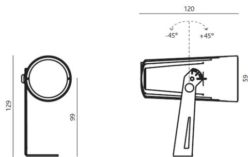
Gehäuse aus stranggepresstem Aluminium, Diffusor aus gehärtetem extra-hellem Glas, symmetrisch abstrahlend 24° mit direktonaler Optik, drehbarer Lichtstrahl 90°, inklusive Anschlusskabel 1m, IK07, UGR <19, IK07, Lebensdauer: 50'000 Std. / L80
