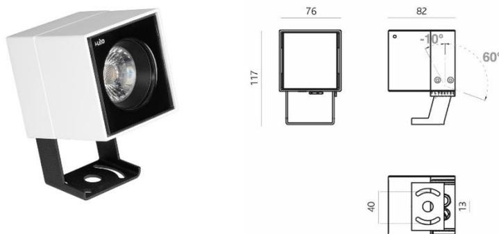
Corps aluminium moulé sous pression, diffuseur verre extra clair, distribution symétrique 37°, faisceau lumineux orientable 70°, inclus câble de connexion 1m, UGR <16, IK09, durée de vie 50'000 h / L80
