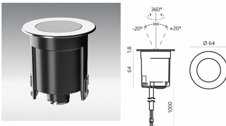
Corps en fonte d'aluminium avec surface noire, couvercle en verre extra-clair, dissipateur thermique en aluminium, lumineux tournant +/- 20°, rotatif 360°, flamme unique, câble de raccordement de 1 m, IK09, charge max 2'500 kg.
