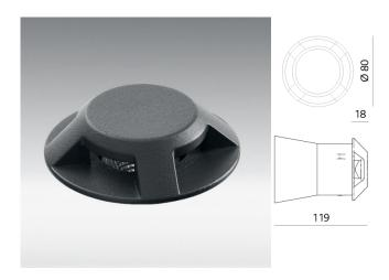
Corps en fonte d'aluminium, finition par poudrage, réflecteur en polycarbonate argent, avec boîtier d'encastrement en aluminium, verre de sécurité transparent, charge max. 6000 kg, IK10, durée de vie : 60'000 h / L90
