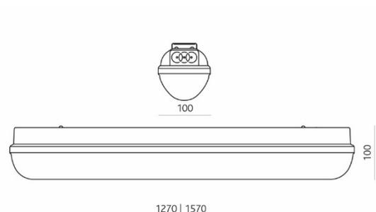
Luminaire à diffuseur pour locaux humides, boîtier en polycarbonate injecté auto-extinguible gris, diffuseur prismatique résistant aux chocs, verrouillage de sécurité affleurant en acier inoxydable pour fixer le diffuseur, ouverture avec tournevis. Support de montage en acier inoxydable, raccordement 230V, câblage traversant possible, EN 60598-2-2, durée de vie: 50'000 h / L85
