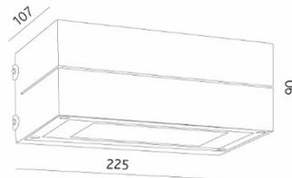
Aluminium-Druckguss, Polyester-Epoxy-Pulverbeschichtung (UV-beständig), Diffusor aus klarem Polycarbonat (UV-beständig), Silikondichtung, IK07, Lebensdauer: 50'000 Std. / L70
