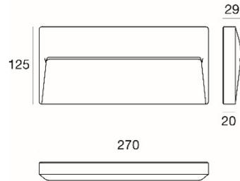
Gehäuse aus stranggepresstem Aluminium, Diffusor aus hellem Glas, asymmetrisch abstrahlend nach unten 121°, inklusive 30cm Anschlusskabel, Lebensdauer: 50'000 Std. / L80
