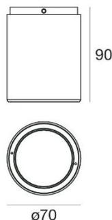
Gehäuse aus stranggepresstem Aluminium, Diffusor aus extra klarem Glas mit Siebdruckbehandlung gehärtet, IK07, UGR <16
