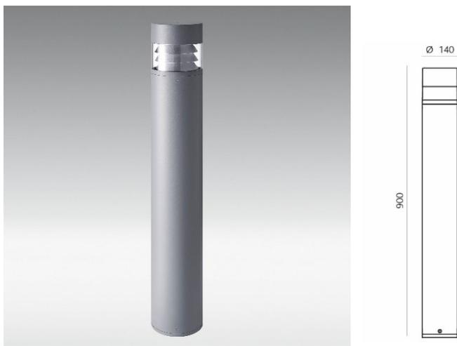
Corps en fonte d'aluminium, finition par poudrage en polyester époxy (résistante aux rayons UV), grille aluminium, diffuseur en polycarbonate transparent (résistant aux rayons UV), joint en silicone
