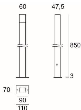
Corps en métal avec revêtement en poudre de polyester et prétraitement de surface protecteur, diffuseur en polycarbonate transparent, émission simple, distribution asymétrique vers le bas de la direction d'émission de la lumière, IK08
