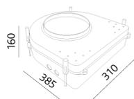
Einbaugehäuse SpotBox Jumbo aus Polycarbonat ist transparent, einbetonierbar und passend zu unseren Produkten „FIRALED Downlight“ 20 W, 28 W und 36 W, inkl. Trafotank.
