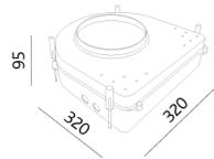
Einbaugehäuse SpotBox Jumbo Flatbox aus Polycarbonat ist transparent, einbetonierbar und passend zu unseren Produkten „Purità“ Downlight 15 W, 20 W und 30 W.
