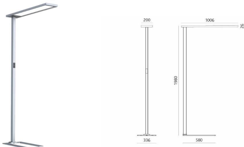
Boîtier en aluminium, diffuseur en polycarbonate micro prismatique, incl. capteur de mouvement et capteur de lumière du jour, y compris arrêt automatique (après 30 min. de gradation à 30 %, après un nouvel arrêt de 30 min.), répartition de la lumière : 25W vers le bas / 75W vers le haut, commutable et gradable via l'écran tactile
