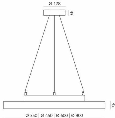
Boîtier en aluminium, y compris la suspension à fil, couvercle anti-reflet, UGR<17, Dali dimmable, durée de vie : 50'000 h / L80
