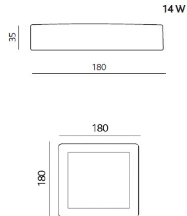
Aluminium-Druckguss, Diffusor aus opalisiertem Polycarbonat, mit integriertem Konverter, nicht dimmbar
