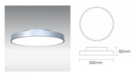
Gehäuse aus Aluminium, Anti-Glare-Abdeckung, UGR<18, Dali dimmbar, Lebensdauer: 50'000 Std. / L80
