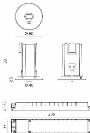
Downlight-Notleuchte EM DL60 elliptisch oder rotationselliptisch besteht aus einem LED-Kopf mit integriertem LFP-Akku, einer zweifarbigen LED-Statusanzeige sowie einem Notlichtbetriebsgerät zum Betreiben der LED in Bereitschaftsschaltung. Die integrierte Selbsttestfunktion entspricht der europäischen Norm.
