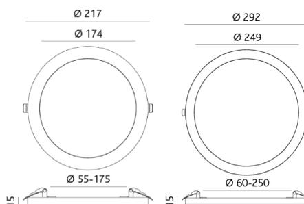
Corps en plastique, peut être monté comme luminaire apparent ou avec les ressorts en saillie comme luminaire encastré, diffuseur satiné (éclairage homogène), convertisseur dimmable intégré, anneau frontal blanc, anneaux avant magnétiques supplémentaires disponibles en différentes couleurs comme accessoires
