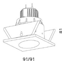
Corps en fonte d'aluminium, ressorts latéraux trapézoïdaux, fermeture à baïonnettes, verre de sécurité satiné, Halogène BT: réflecteur argent inclus, Halogène HT: borne en céramique, câbles gainés de silicone et de soie de verre
